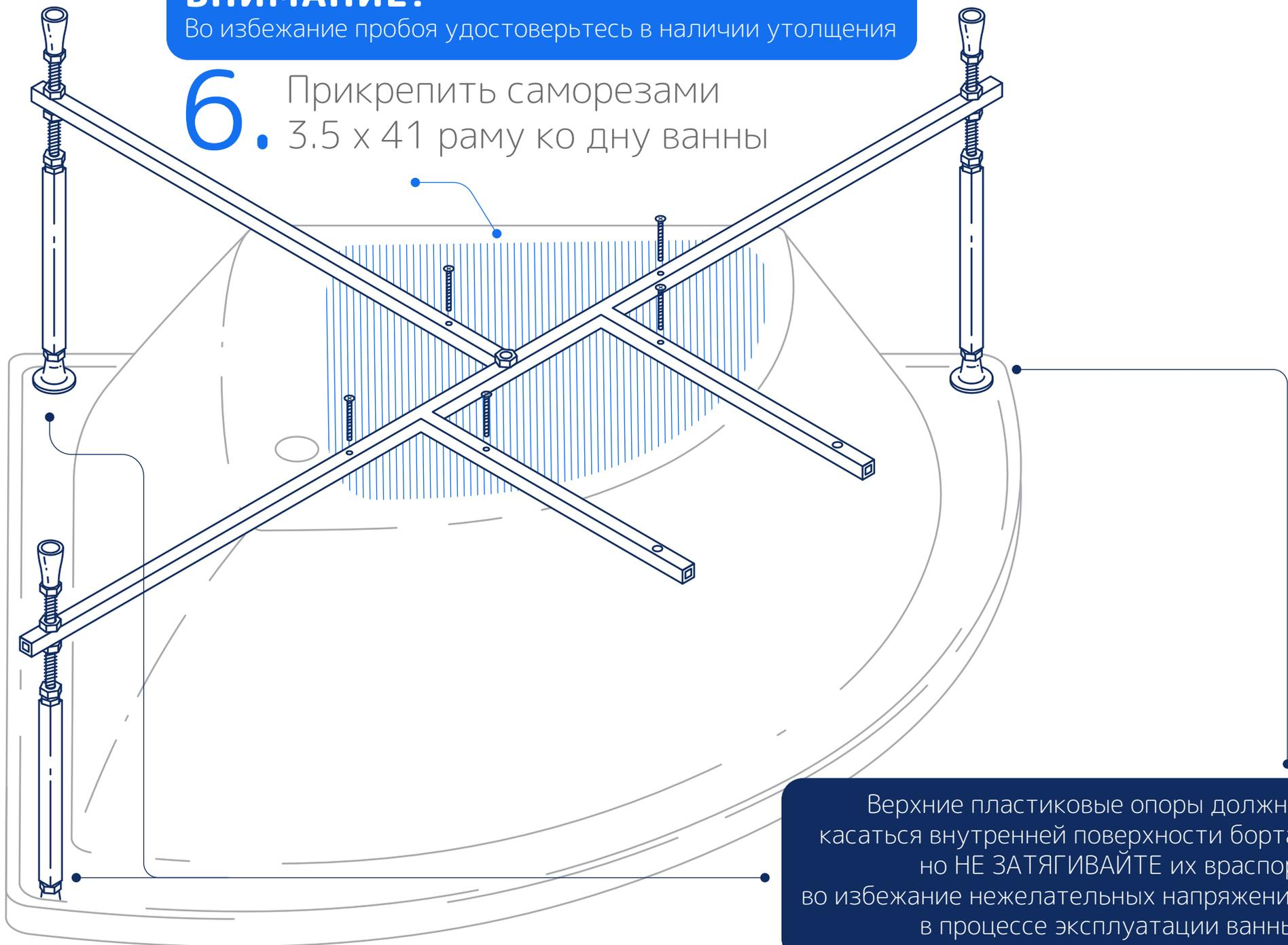
Верхние пластиковые опоры должны касаться внутренней поверхности борта, но НЕ ЗАТЯГИВАЙТЕ их враспор, во избежание нежелательных напряжений в процессе эксплуатации ванны!
