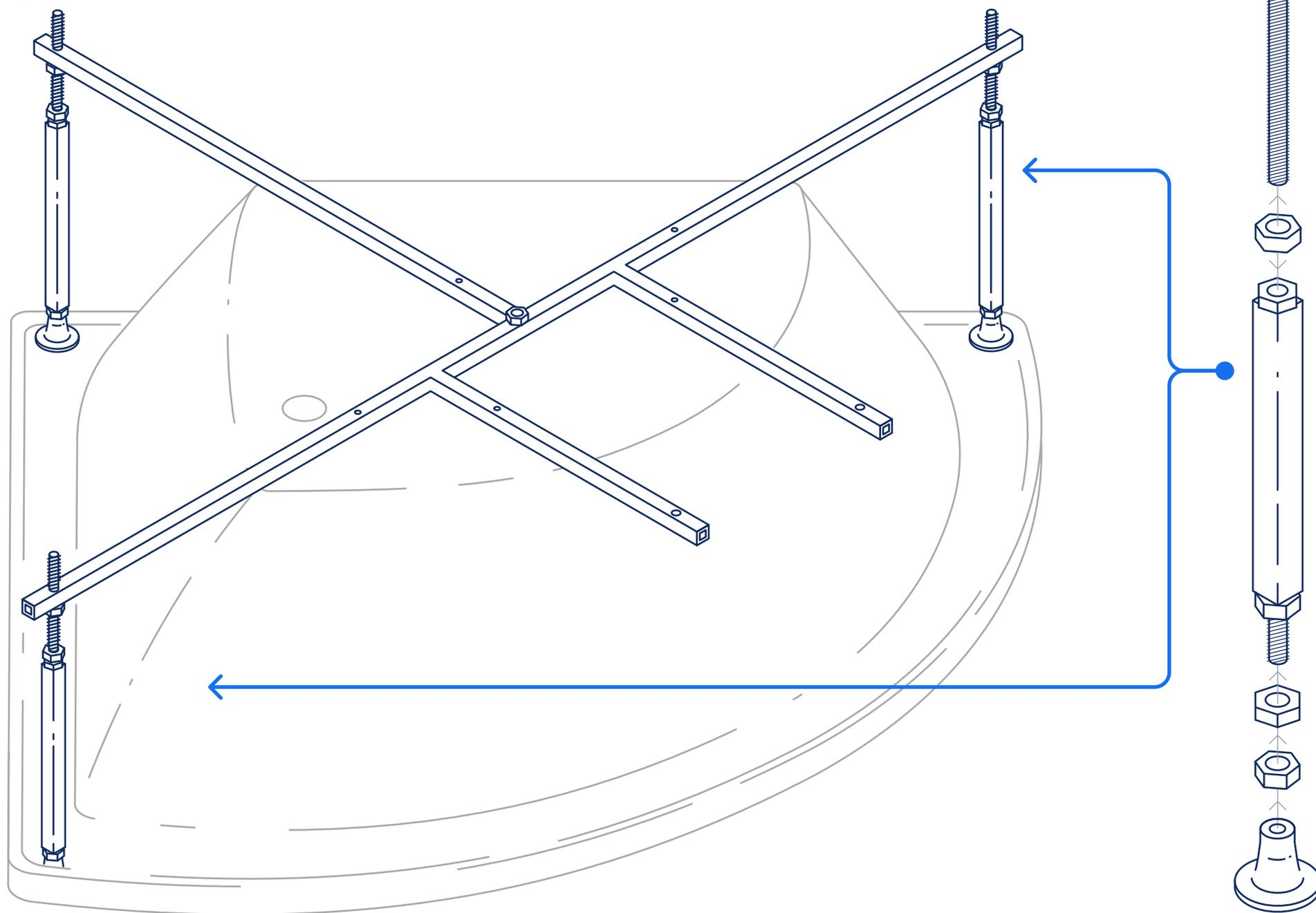
4. Установить нижние опоры с гайками на шпильки
