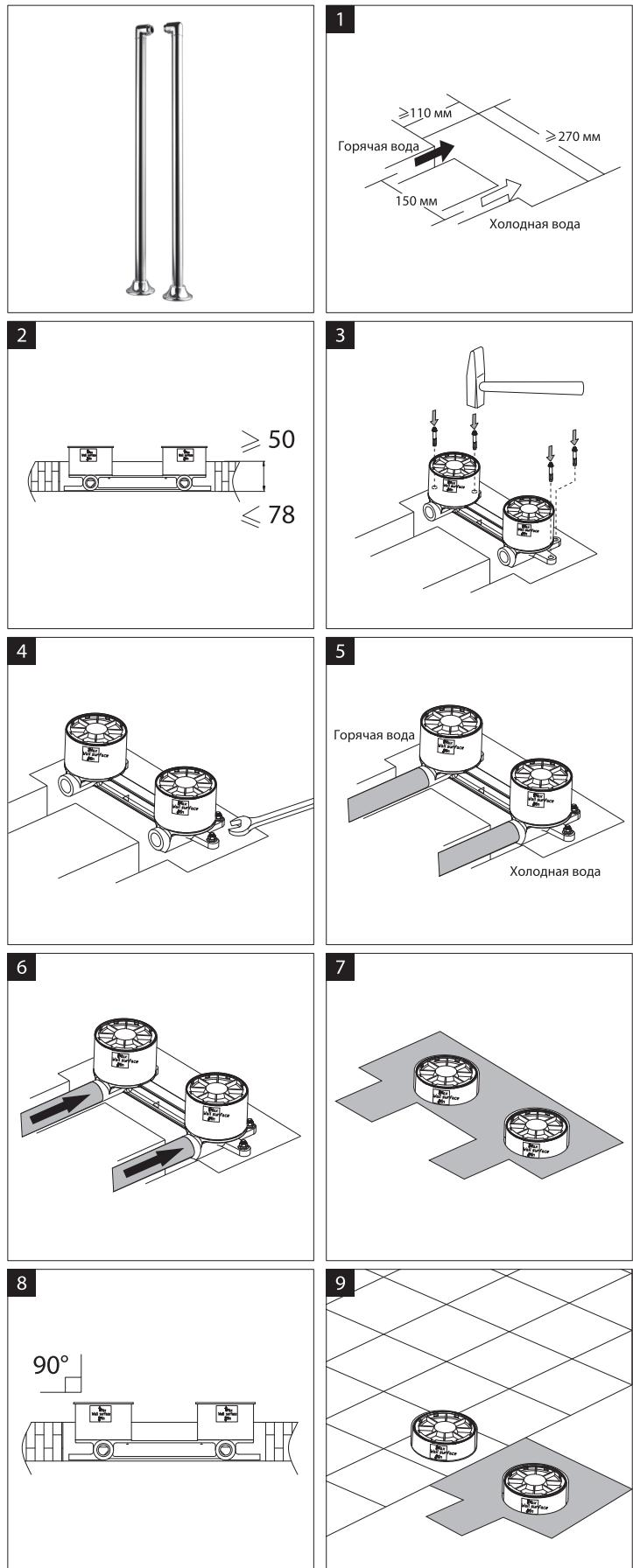
снимите 2 пластины установочного узла. Винты потребуются при установке – отложите их для дальнейшего использования;
