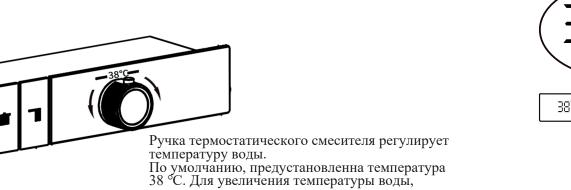
нажмите на кнопку, расположенную сверху ручки термостата и поворачивайте по часовой
