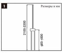
1.Определите высоту от пола до встраиваемого корпуса смесителя и до верхней душевой лейки. На рисунке указана рекомендуемая высота установки.
