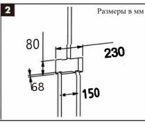
2.Подготовьте место для установки внутренней части смесителя и труб PPR в соответствии со схемой.
