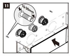
11.Соедените корпус смесителя с фитингами и в соответствии с монтажными шпильками. Убедитесь, что зафиксируйте корпус смесителя на корпус смесителя плотно прилегает к
