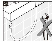
24.Подсоедените шланг ручного душа к корпусу смесителя снизу без использования инструмента, затяните гайку шланга руками.
