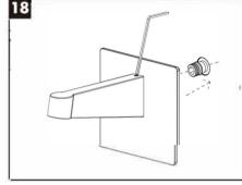
18. Наденьте кронштейн с планкой на фитинг и зафиксируйте винтом при помощи шестигранного ключа.
