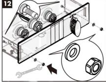
12. Наденьте шайбы и гайки на монтажные шпильки и плотно стене гайками.
