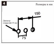
4.Сделайте 3 монтажных отверстия в керамической плитке диаметром 35 мм. Расстояние между отверстиями должны соответствовать схеме.
