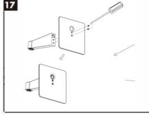
17. Соедените кронштейн с крепежной планкой при помощий двух винтов.
