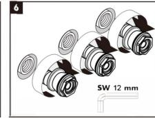
6.Вкрутите фитинги в корпус смесителя при помощи шестигранного ключа на 12 мм
