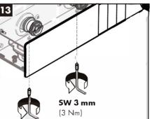
13. Зафиксируйте снизу, корпус смесителя, фиксирующими винтами.
