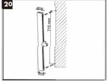
20. Приложите душевую штангу к стене, отметьте места крепления. Просверлите отверстия и вставьте в них дюбели.
