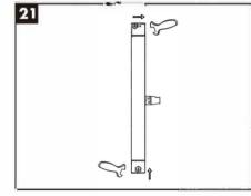
21. Прикрутите душевую штангу к стене саморезами с зазором штанги 6-8 мм от стены. Затем вставьте в штангу держатель ручной лейки и затяните саморезы при
