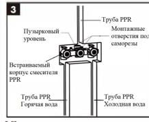
3. Поместите корпус смесителя в подготовленное место, отметьте места крепления, просверлите отверстия, вставьте дюбели и закрепите корпус смесителя саморезами.
