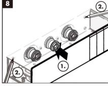
8. Приложите корпус смесителя к стене и наметьте отверстия на стене, для монтажных шпилек.
