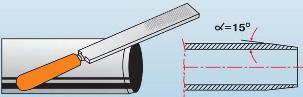
оси. С наружной поверхности торца трубы снять фаску напильником.
