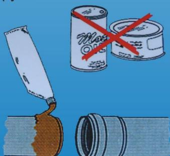
Для уменьшения осевого усилия при монтаже можно использовать специальную силиконовую смазку (нельзя использовать масла или минеральные смазки).
