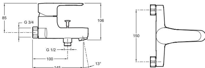
Спецификация продукта: Однорычажный смеситель для ванны/душа. E16031-4. Коллекция: JULY. Вес: 1,6 кг. Расход воды: 21 л/мин при давлении 3 бар. Расстояние между центром излива и центральной осью корпуса: 145 мм. Механизм: Картридж с регулируемым ограничителем температуры и чувствительным ограничителем расхода воды. Разметка отверстий: 150 мм. Обратный клапан на выходе для душа.
