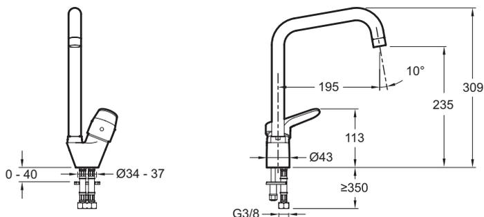
Спецификация продукта: Однорычажный смеситель для кухни, поворотный излив. E75770. Коллекция: BRIVE. Вес: 1,3 кг. Тип установки: 1 отверстие. Расход воды: 11 л/мин при давлении 3 бар. Высота под изливом: 309 мм. Расстояние между центром излива и центральной осью корпуса: 195 мм. Подключение: С гибкой подводкой. Механизм: Керамический картридж. Аэратор с антиизвестковым покрытием. Поворотный излив 360°С. Расход воды: 11 л/мин при давлении 3 бар. Картридж C3 для экономии воды и энергии.
