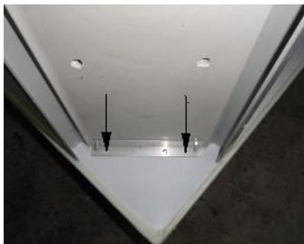
После установки душевой кабины на поддон и закрепления ее на поддоне, к наружной стороне центральной стойки приложите усилитель сиденья /4/ и через алюминиевый профиль прикрепите его к поддону. **Внимание! Не затягивайте винты до упора. Это позволит регулировать их положение в ходе дальнейшей установки. Затяните винты только по окончании полной установки откидного сиденья.**
