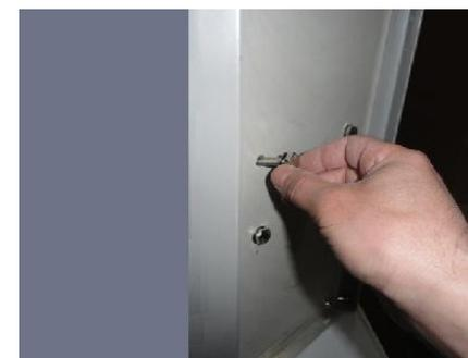
С помощью сверла, входящего в комплект откидного сиденья, со стороны усилителя сиденья через отверстия на усилителе сиденья просверлите отверстия на центральной стойке.
