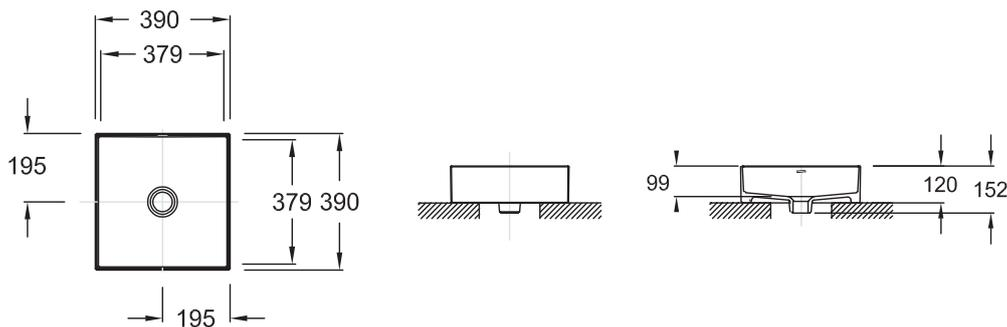
Спецификация продукта : Раковина 39 см. E90011. Коллекция : DELTA PURE. РАЗМЕРЫ (CM) : 39 x 39 см. ВЕС : 10 кг. МАТЕРИАЛ : Огнеупорная керамика. ТИП УСТАНОВКИ : Накладные.
