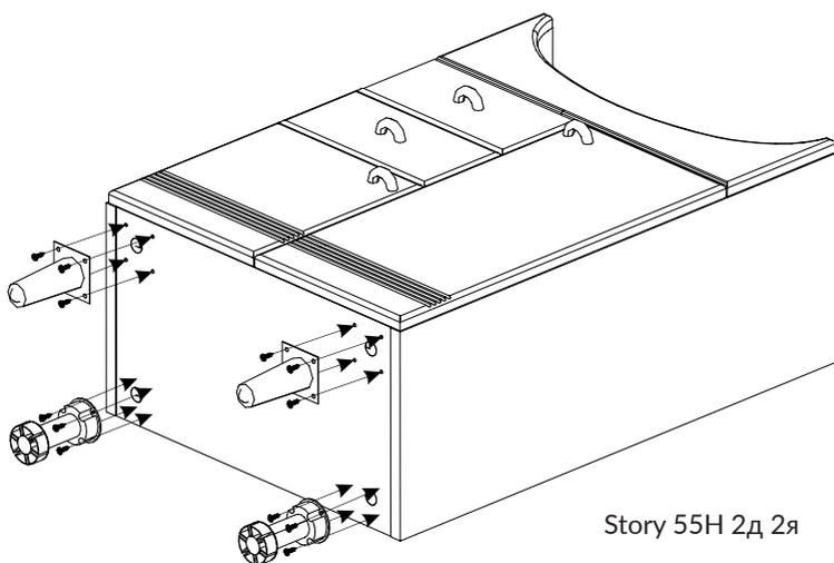
Положить тумбу задней частью на мягкую поверхность. Установите опоры с помощью саморезов 3.5x16, предварительно сняв заглушки в местах крепления.
